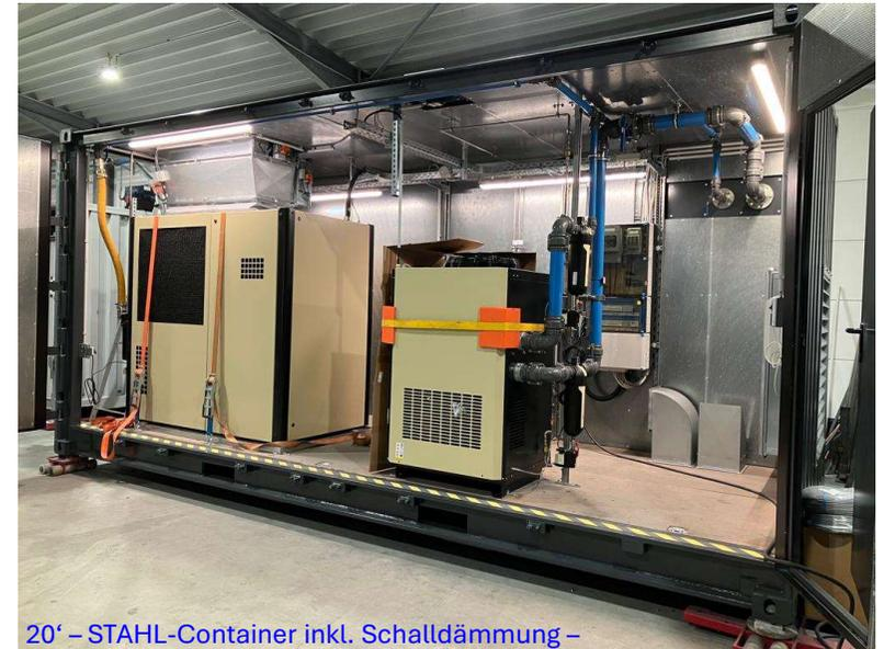
20' – STAHL-Container inkl. Schalldämmung –
