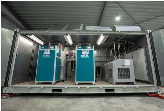
20' – STAHL-Container inkl. Schalldämmung –
